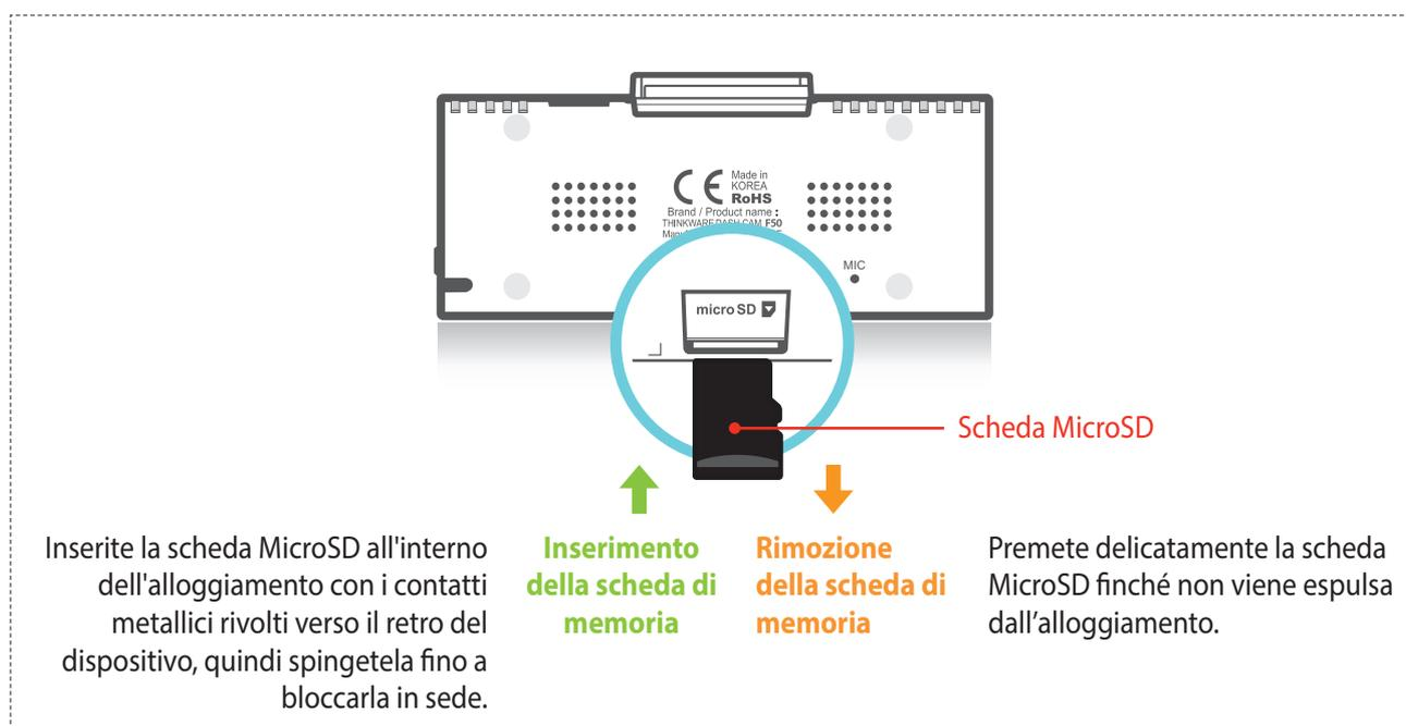
Non applicate eccessiva forza sulla scheda microSD e non tentate di inserirla nella direzione errata per evitare di causare danni alla scheda microSD e all'alloggiamento della scheda.
